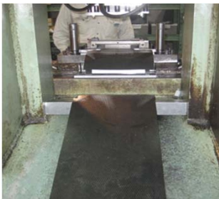
途中で製品が 止ってしまったり シューターが 外れてしまい面倒
