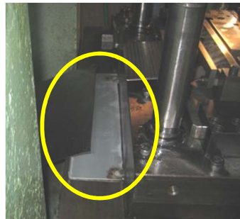
途中で製品が 止ってしまったり シューターが 外れてしまい面倒
