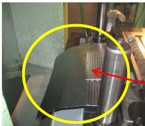
途中で製品が 止ってしまったり シューターが 外れてしまい面倒
