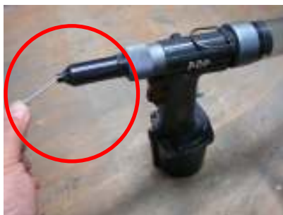
リベッターにリベットをセット。 リベッターが多少は 吸い込むのですがやはり手間です...
