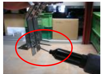
リベットが1個ずつ決まった 場所に出ますので リベッターを近付けるだけで セット完了♪
